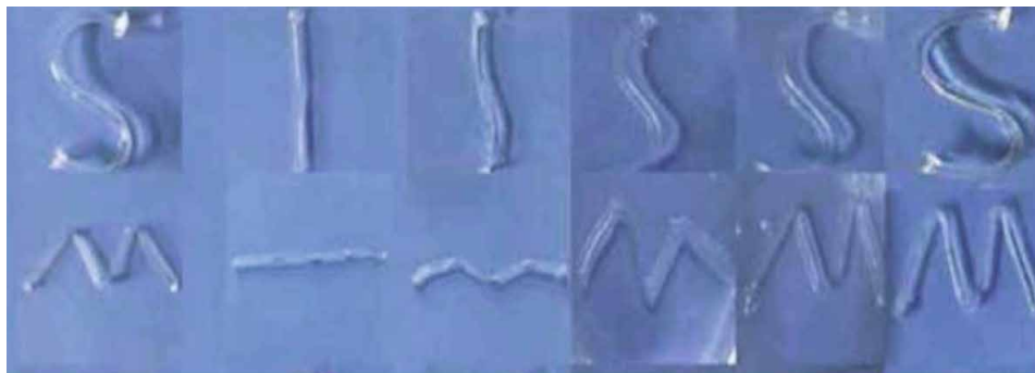
Исходная форма Распрявленный образец Через 10 мин Через 20 мин Через 30 мин Через 45 мин ПРИ ПОГРУЖЕНИИ В ВОДУ
