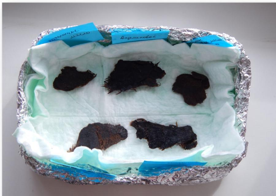
*Рис. 3. Образцы перед сушкой в морозильной камере*
