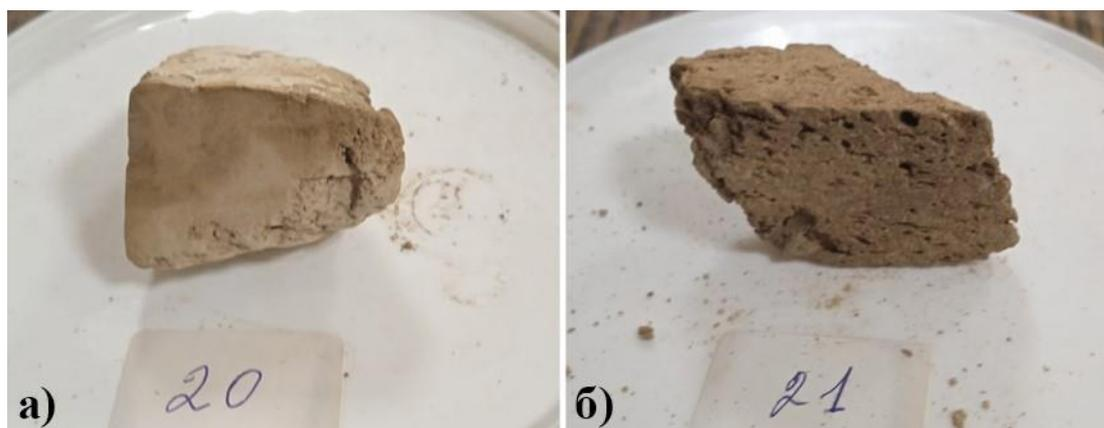
Ил. 3. Распределение консолиданта по глубине пропитки образцов необожжённой глины: а – образец с красочным слоем (20); б – образец без красочного слоя (21)
