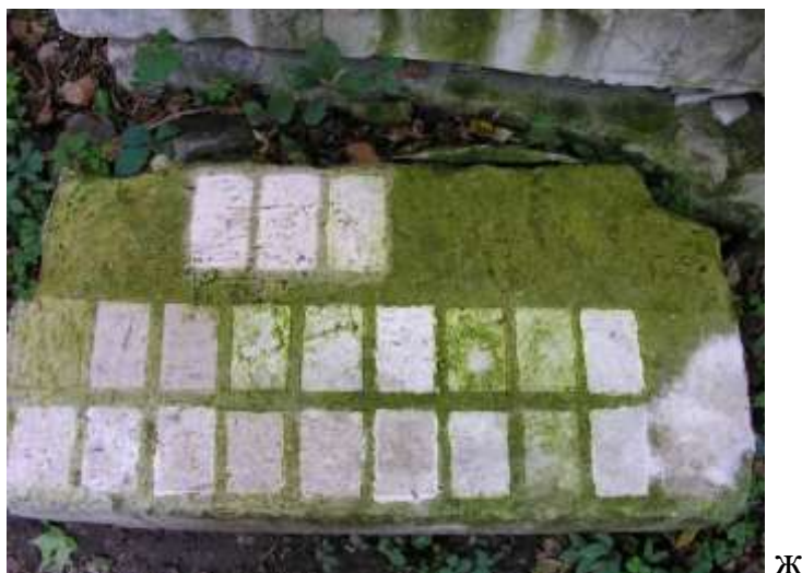
Рисунок 12 - Расчищенный блок известняка, разделенный на экспериментальные площадки: а) отсутствие визуально наблюдаемых признаков повторной колонизации, 14 дней после расчистки; б) – реколонизация необработанных участков, 25 дней после расчистки; в) – начало повторной колонизации площадок №1, №7 и №8, 25 дней после обработки, 7 дней задержки роста в сравнении с необработанным камнем; г) – повторная колонизация на площадках №1, №7, №8 и №17, 49 дней после обработки; д) – площадки №1, №2, №3, под ними №11, №12, №13, 49 дней после обработки; е) – площадки, расчищенные и обработанные Bellinzoni, Bellinzoni с капатоксом и катамином АБ, верхний ряд, 20.08.18; ж) – повторная колонизация площадки, обработанной Bellinzoni, 38 дней после обработки.
