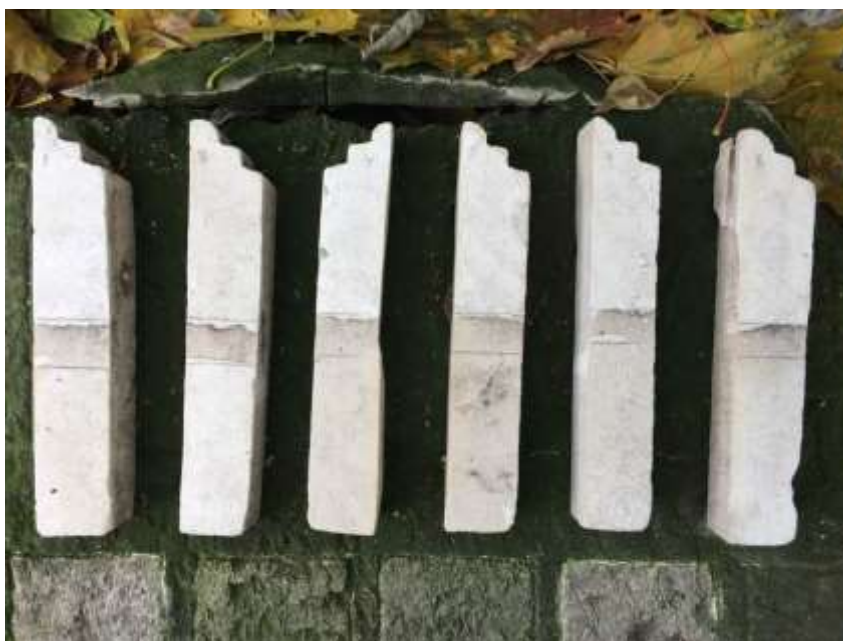
Рисунок 23. Образцы известняка через 48 дней экспонирования на открытом воздухе. Сорбция поверхностных загрязнений на необработанных участках стала заметнее. На нижней части образца 4 (катамин АБ + Funcosil SNL) и образца 5 (Сараток + Funcosil SNL) загрязнений больше, чем на верхних частях, обработанных только Funcosil SNL. 8.10.19
