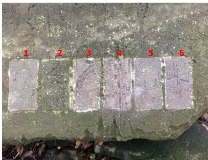
Рисунок 17. Тестовые площадки через 70 дней экспонирования на открытом воздухе в тени дерева. Рост водорослей возобновился на необработанном камне вокруг тестовых площадок. Площадка 2, обработанная Funcosil SNL отличается по цвету от остальных площадок 4.11.19
