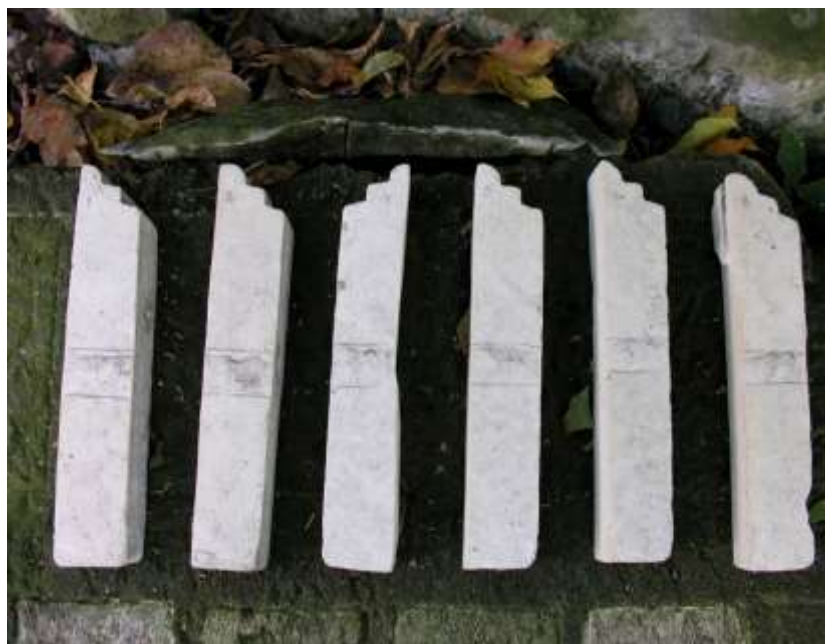
Рисунок 22. Образцы известняка через 27 дней экспонирования на открытом воздухе. Сорбция поверхностных загрязнений заметна на необработанных участках камня (центральные). 17.09.19
