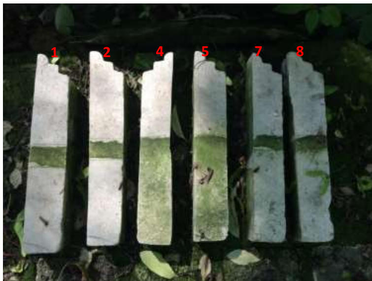
Рисунок 26. Образцы известняка через 9 месяцев и 21 день экспонирования на открытом воздухе. Водорослевая био пленка мало отличающаяся от контрольных участках на нижней половине образца 4, катамин АБ + Funcosil SNL и образца 5, Сараток + Funcosil SNL. Начало колонизации нижней части образца 7, катамин АБ+АКЕМИ и образца 8, Сараток+АКЕМИ. 11.06.20
