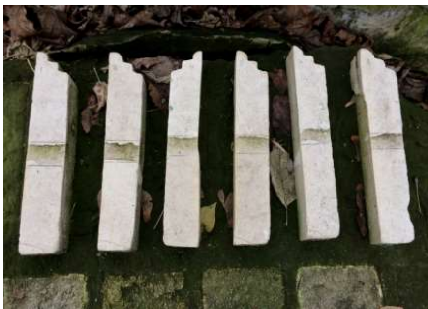
Рисунок 25. Образцы известняка через 89 дня экспонирования на открытом воздухе. На необработанных участках начался рост визуально наблюдаемых водорослевых биопленок. 19.11.19
