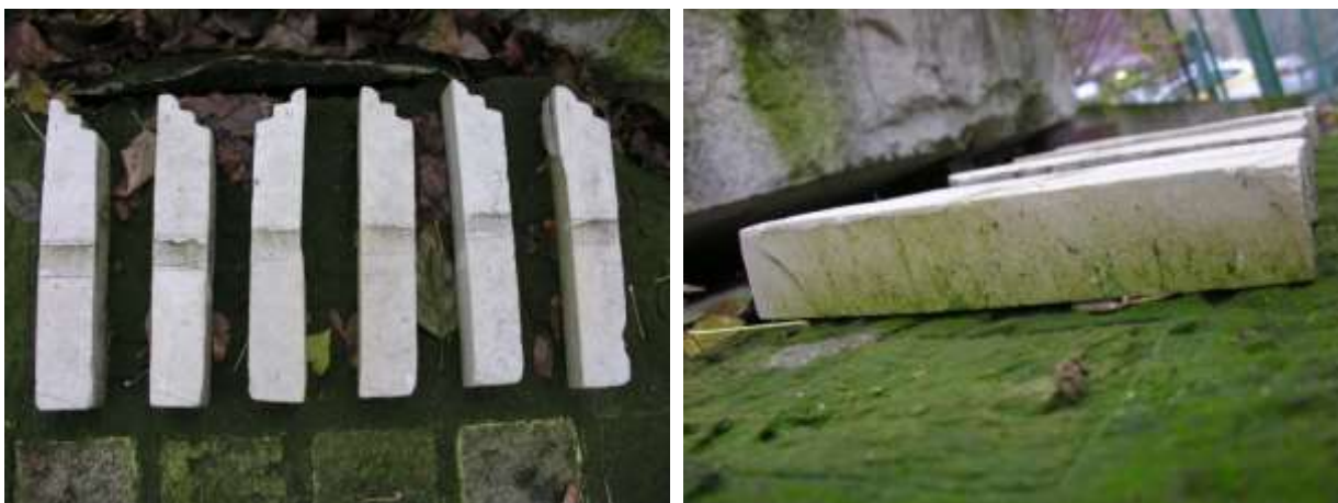
Рисунок 24. Образцы известняка через 82 дня экспонирования на открытом воздухе. На боковой поверхности, увлажняемой за счет отражения падающих дождевых струй, начался рост визуально наблюдаемых водорослевых биопленок. 10.11.19
