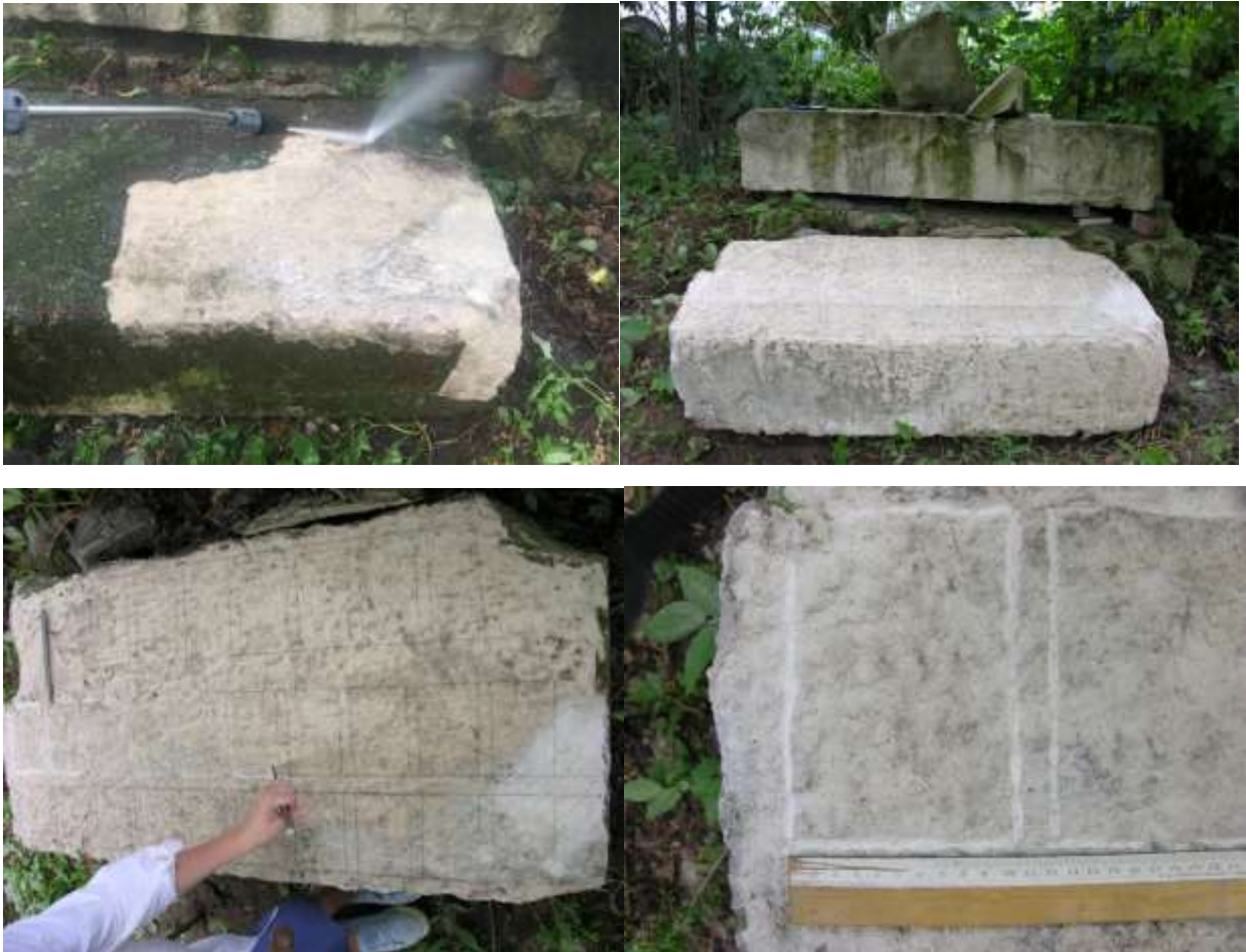
Рисунок 6. Расчистка блока №1 струёй воды под давлением. Поверхность блока разделена на тестовые площадки. Границы тестовых площадок вырублены в камне. Размер одной тестовой площадки 10 x 15 см.
