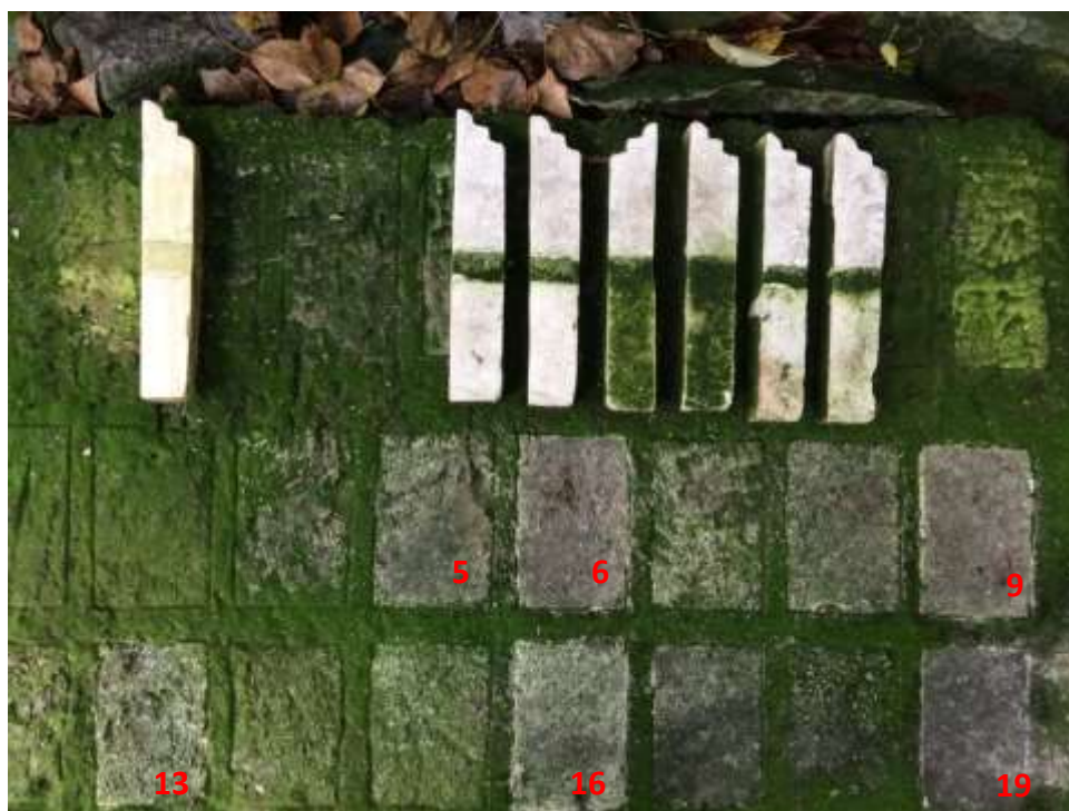
Рисунок 14. Блок №1. Площадки через 2 года и 2 месяца после обработки: площадка 5 - Акемі, два раза; площадка 6 – МСМ-7, 2 раза; площадка 9 – ВФА + МСН-7; 13 – Саратокс + МСН-7; площадка 16 – катамин АБ + МСН-7; 19 – МСМ-7, 1 раз
