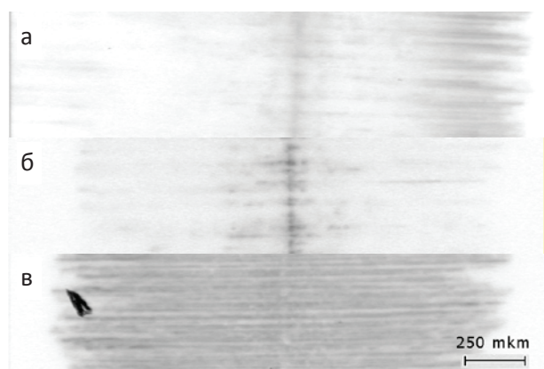
Рис. 1. EBIC изображения следов за дислокациями а) со стороны сжатия; б) со стороны растяжения; в) тот же участок (б) образца после следования дислокаций в обратном направлении.
